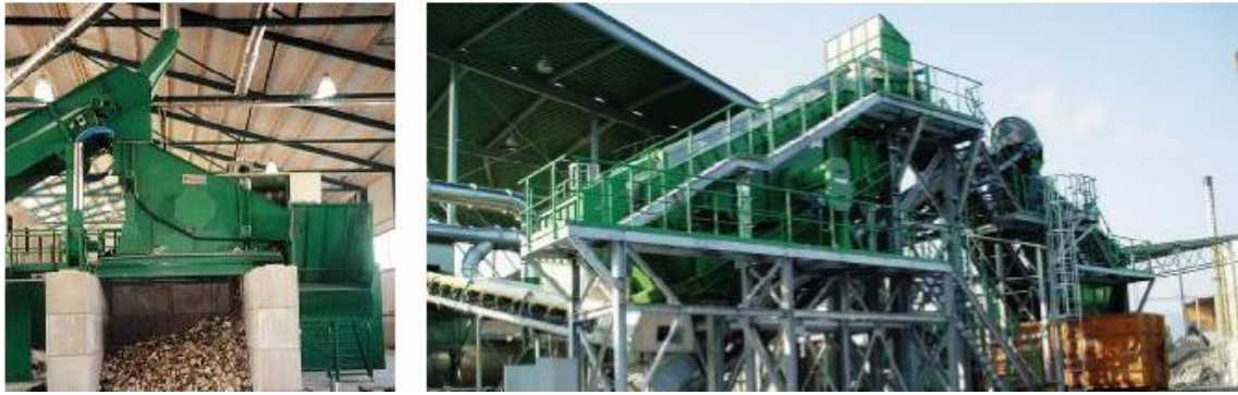
Figura 9 - Sistema de separação das frações dos RSU (Kuttner, 2013).
