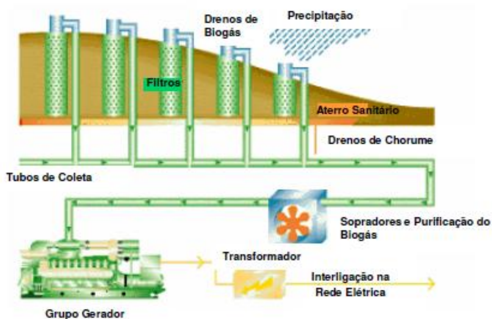
Figura 13 - Aproveitamento energético do biogás de aterro sanitário (PECORA et al., 2008).
