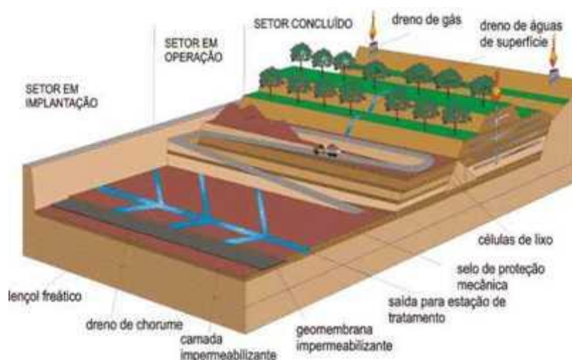
Figura 11 – Ilustração de um aterro sanitário (GrandeBahiaonline 2013).
